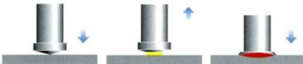
Az ívhúzásos csaphegesztési eljárás működési elve
