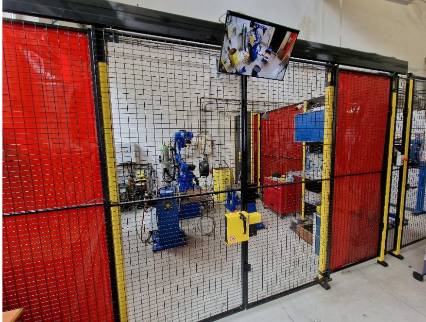
Hegesztőrobotot elszigetelő biztonsági cella
