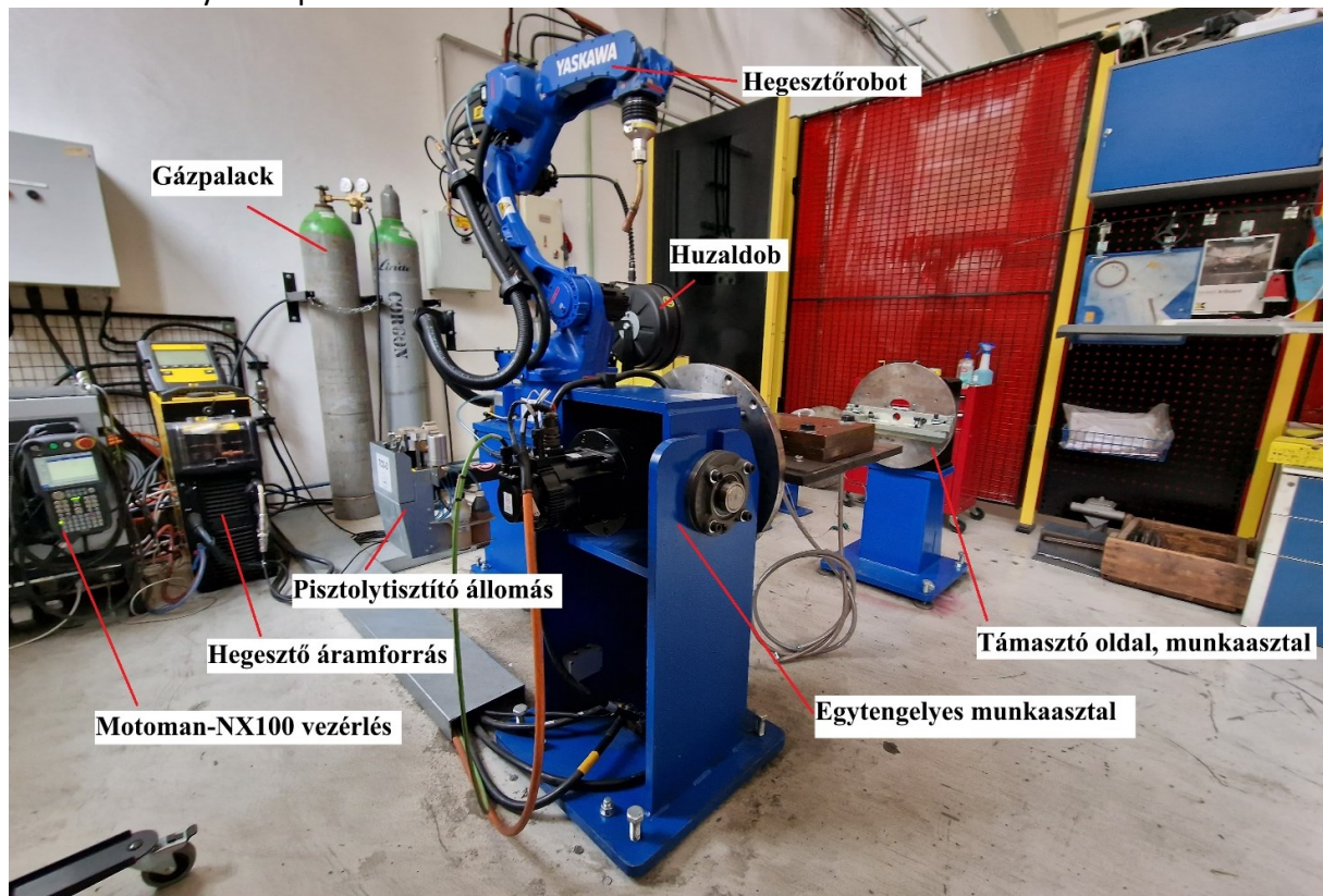
A robotcella felépítése
